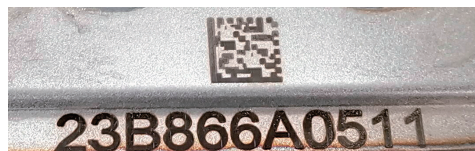
(a) 製品番号とQRコードのレーザー刻印の様子
