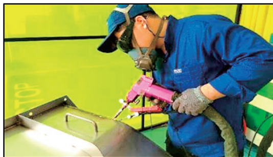
図4 ファイバーレーザー溶接の活用
