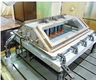
図2 成膜装置扉 製罐・切削加工
