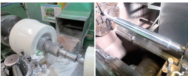
図7 モールド製品、駆動軸の旋盤加工
