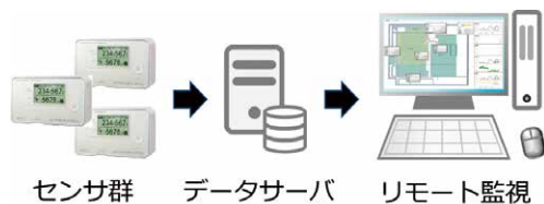
図4 環境モニタリングシステム
