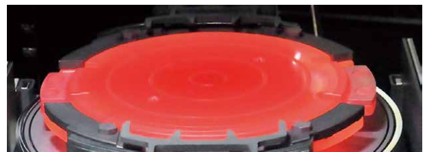
図3 機械的なクランプ構造を追加した静電チャックモジュール
