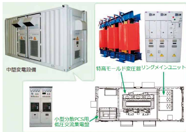
図2 22kV パッケージ型中間変電設備
