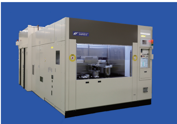
図2 SiCパワーデバイス向けイオン注入装置“IMPHEAT”
