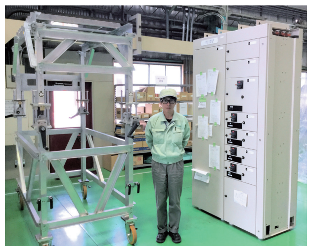
図1 左：タオレンゾー（門型タイプの制御盤等移送治具） 右：コントロールセンタ
