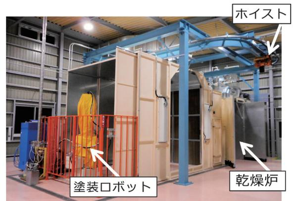
図12 新塗装工場の塗装設備
