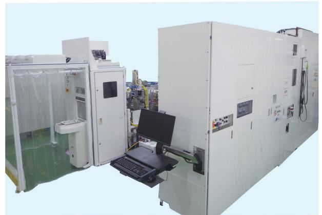
図3 イオンミリング装置外観
