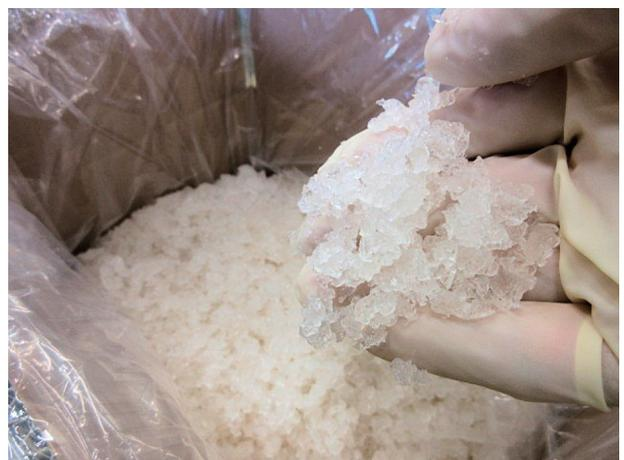
図4 コンクリート養生用途CMCゲル
