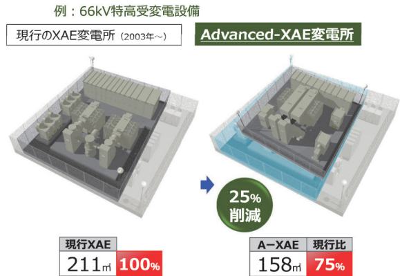
図3 変電所面積の比較
