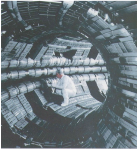
図1 核融合炉 (JT-60) 内部
