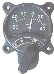
図3 航空機用計器 (電気抵抗温度計)
