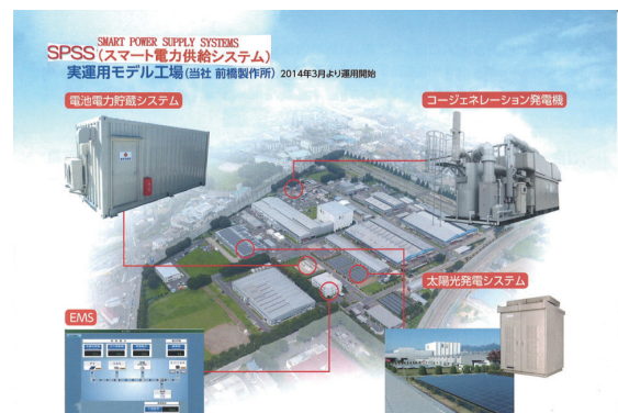
図13 SPSS (スマート電力供給システム)
