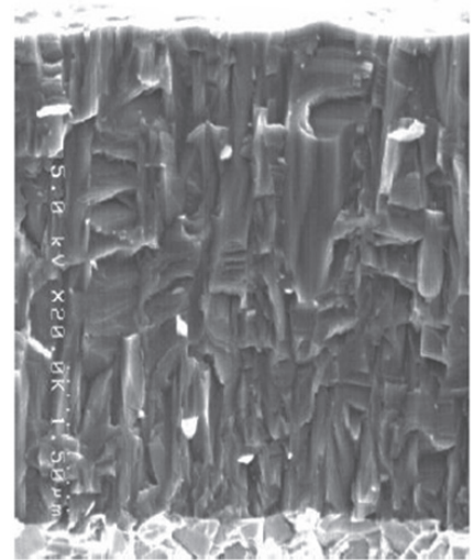
図4 TiAlN膜の断面SEM写真
