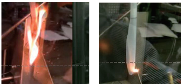
図1 EVAフィルムの燃焼試験（左：未処理、右：難燃処理）
