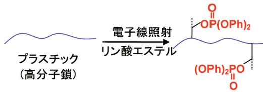
図4 難燃化プラスチックの反応工程概要
