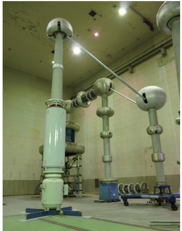
図1 765kV ガスVT耐電圧試験
