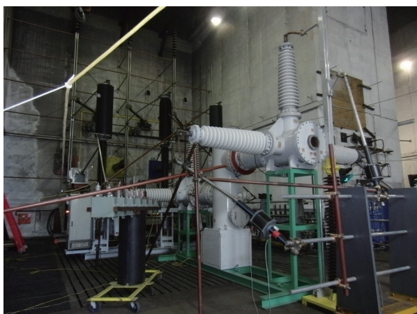
図3 145kV GCB短絡試験（オランダ KEMA試験所）
