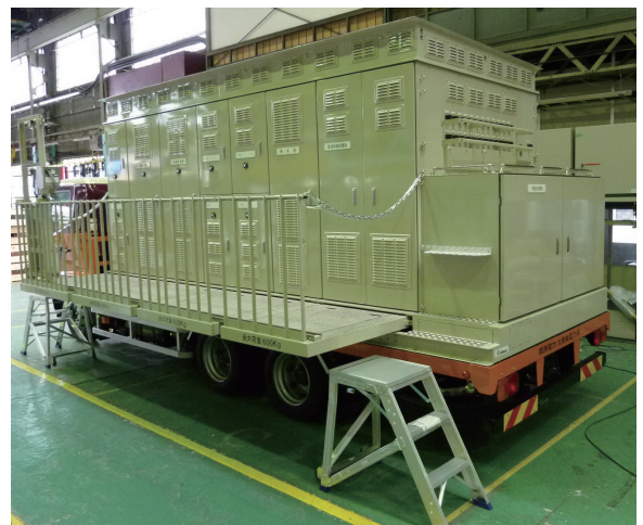
図3 トラック搭載形移動用キュービクル
