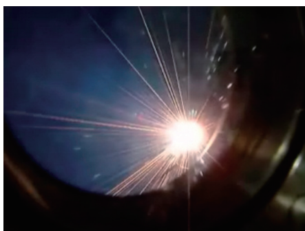
図9 通常放電時におけるパーティクル放出状況
