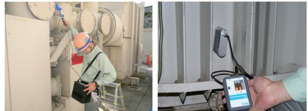
図4 部分放電測定装置による測定
