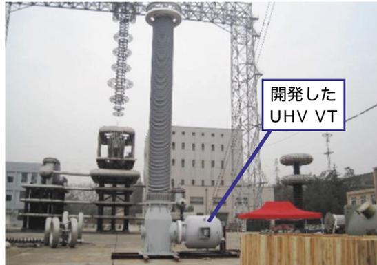
中国国家電力工業電気設備質量検査測定センターでの試験状況
