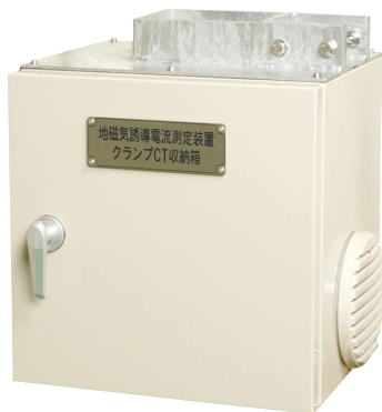
図12 クランプCT収納箱外観
