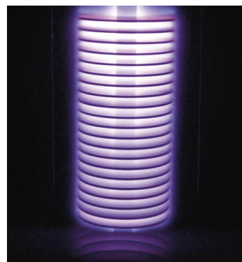
図3-2 複数の円盤形状物を狭ピッチで処理したときの放電状態
