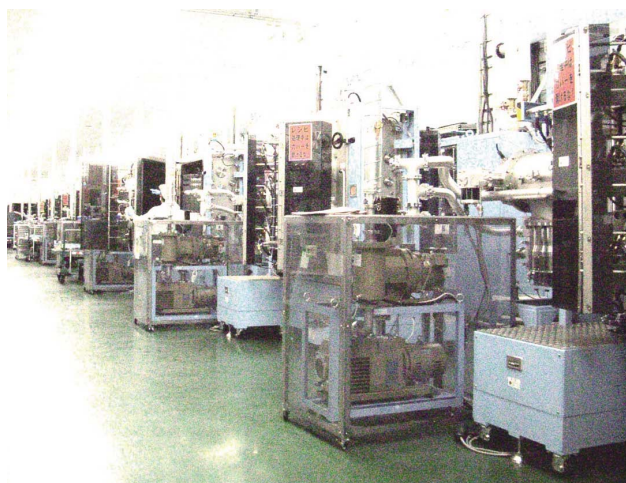
図6 水素フリーDLCコーティング装置の写真
