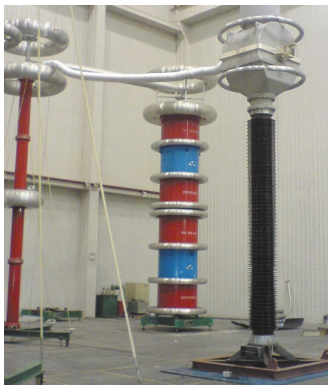
図8 油入倒立形CT型式試験状況
