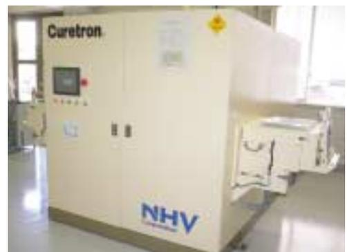
250kV電子線照射装置
