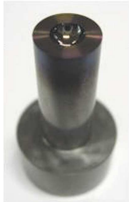
(b) レンズ成型用超精密金型の一例
