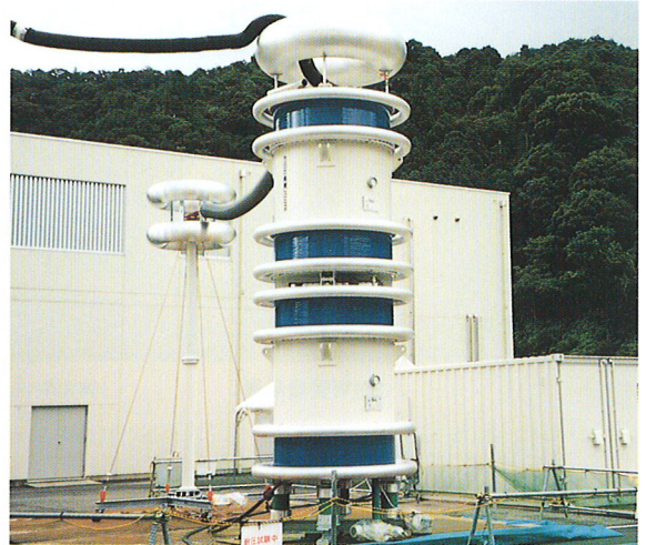
現地試験用共振型AC試験装置 (本文21ページ)
