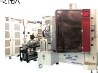
DLC膜コーティング装置「MF720」
