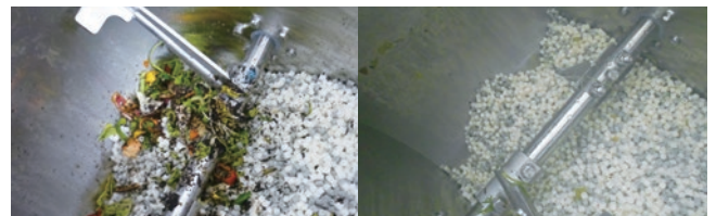
生ごみ処理機の導入(左:ごみ投入直後、右:24時間後の状態)
