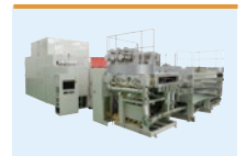
FPD製造用イオン注入装置
