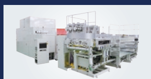
FPD製造用イオン注入装置
