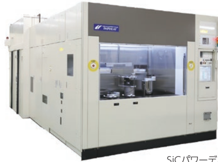
SiCパワーデバイス用 イオン注入装置「IMPHEAT-II」
